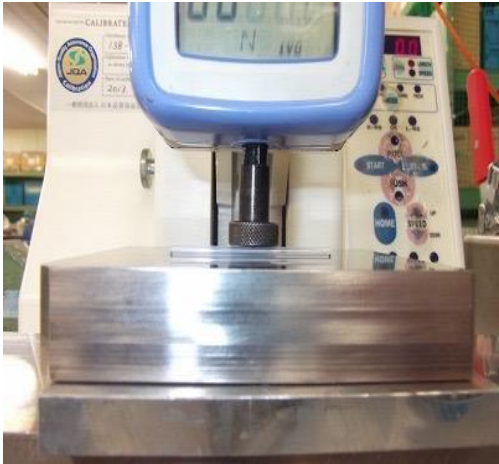
チューブが潰れる際の変位vs荷重を測定する
